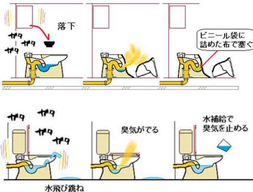
図 2-3-4 破損した便器の対応・封水の補給（入居者）
